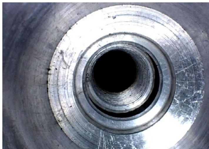
Foto boven: Inspectie van een bougiepoort
